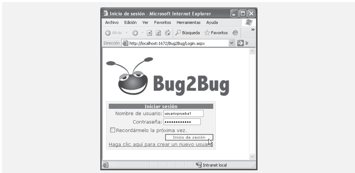
Figura 21.47 | Inicio de sesión mediante el uso del control Login .
