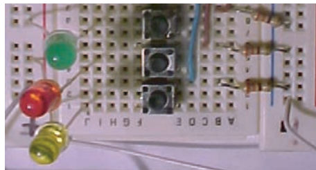
Fotografía del circuito de entrada usando interruptores de no retención normalmente abiertos push micro NO
