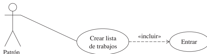
Figura 2-5 Ejemplo de un estereotipo incluir —usado para representar reutilizar — en la dependencia entre “Crear lista de trabajos” y “Entrar”.
