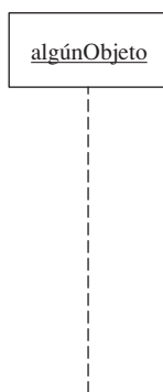
Figura 4-1 Una línea de vida de un objeto representa un ejemplo de una clase y una línea colocada de manera conveniente para permitir la conexión de objetos por medio de mensajes.
