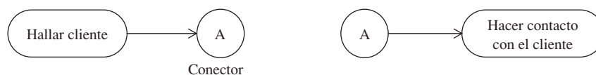
Figura 3-6 Se puede usar un nodo conector con el fin de simplificar los diagramas de actividades que se ven muy abarrotados.
