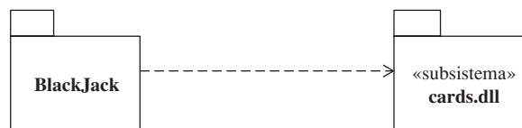
Figura 5-14 El diagrama muestra que el paquete “BlackJack” depende del paquete “cards.dll”, en el cual se usa el estereotipo «subsistema».
